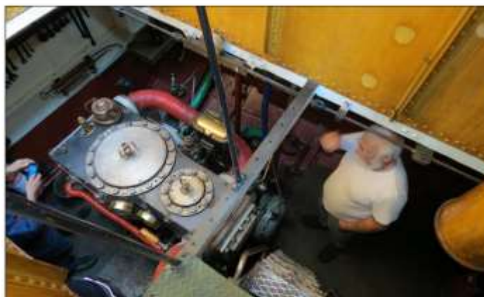
Komposnadmashinen från ovan med topplocken på den lilla högttrycksylindern och den stora lågttrycksylindern. Maskinisten Stellan Rietz håller ett vakande öga under provturen. Foto Gunnar Söderberg 10 september 2020.
